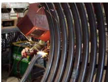
Pendant ce temps, à l'étage supérieur, des échangeurs thermiques adaptés sont produits.
