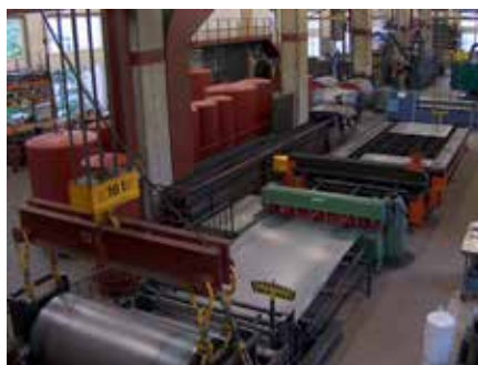
Des accumulateurs individuels ou en série sont tirés d'un rouleau en acier de 16 tonnes.
