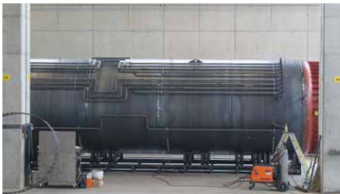
En production: accumulateur avec tubes pré-soudés
