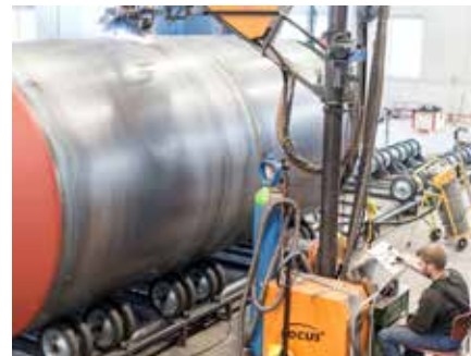
Soudure de l'accumulateur (manteau, font, couvercle, etc.).
