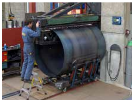
La soudure en longueur se fait automatiquement.
