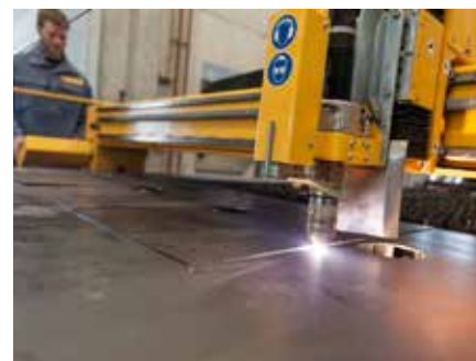
Les raccords sont coupés dans la tôle par la machine au plasma.
