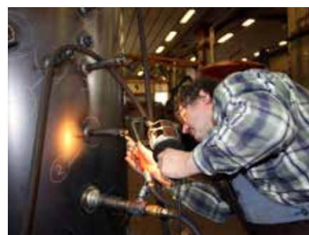
Chaque accumulateur est rempli d'eau et contrôlé très minutieusement.
