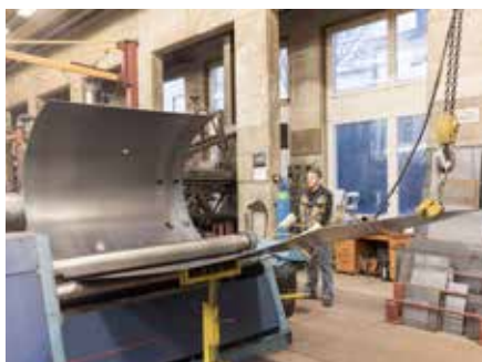
Le manteau de l'accumulateur est arrondi.
