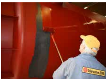
La finition se fait avec une couche d'antirouille.
