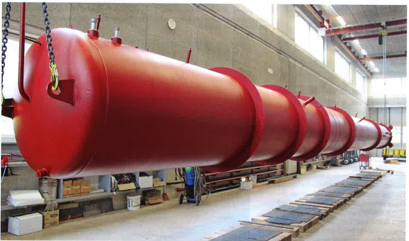
Kernstück des Heizkonzepts im Plusenergiehaus ist «Le cigar»; der Warmwasserspeicher in der Werkstatt der Firma Jenni in Burgdorf.
