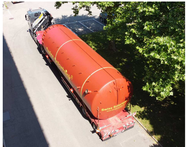
83 000 Liter Speicher zur Abwärmenutzung beim Mineralwasserhersteller Aproz
