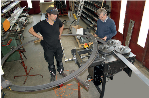
Neue Maschine zum Biegen von Verstärkungsringen für Grossspeicher
