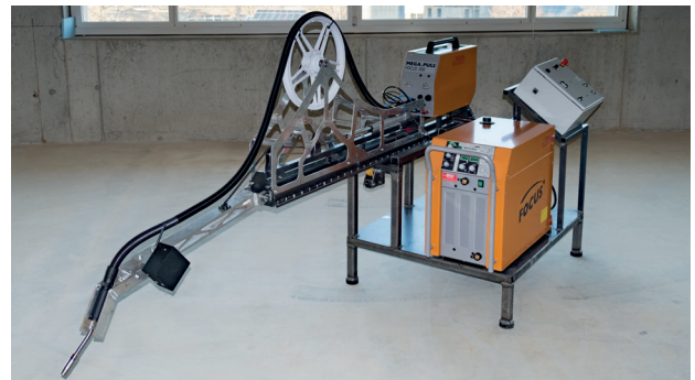
Neue Innenschweissmaschine in Arbeit, noch ohne Kameras, Lasersteuerung und Rauchgasabsaugung.
