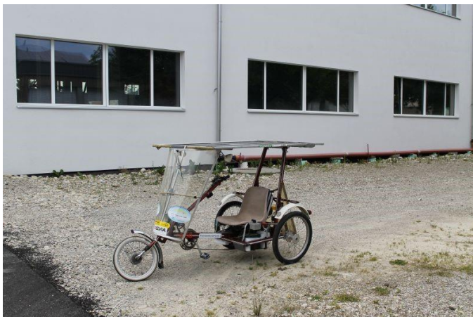
Ultraleichtbau und mit dachintegriertem Solarmodul
