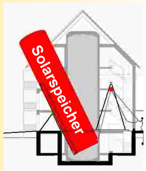
Speichereinbringung nur mit Muskelkraft.
