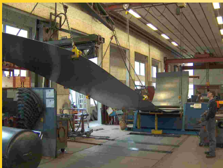
Eines der über 12 m langen Mantelbleche wird gerundet. Aktuelle Bilder finden Sie laufend auf www.jenni.ch .
